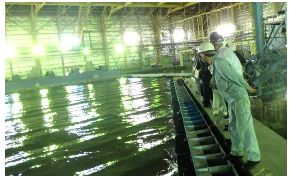
平面水槽における実験イメージ
